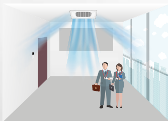
Внутренний блок автоматически запускается при обнаружении людей в помещении.
