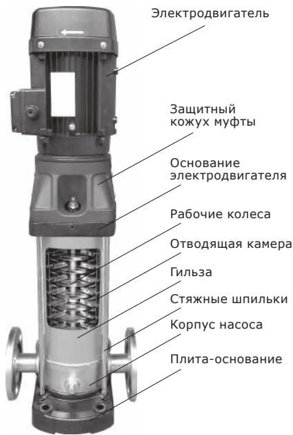
Рис. 3 Насос серии CRV-C
