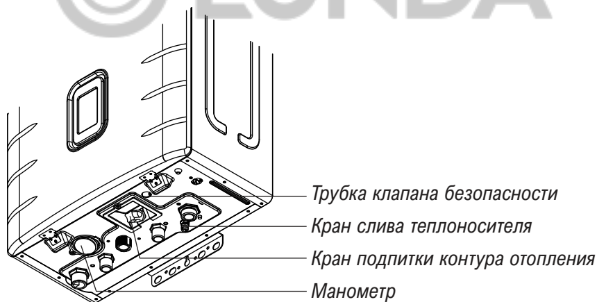
Рисунок 5. Схема нижней панели котла.
