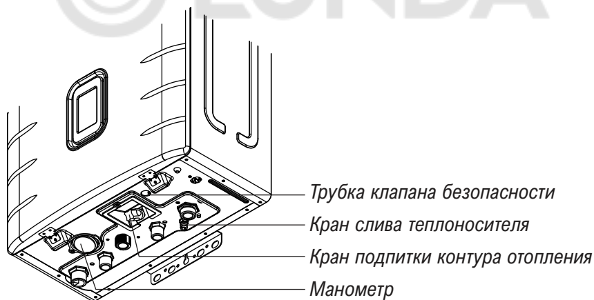
Рисунок 5. Схема нижней панели котла.
