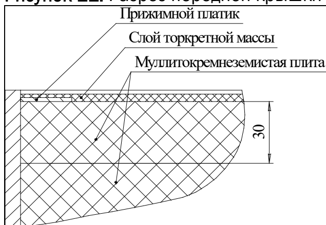
Рисунок 11. Разрез передней крышки
