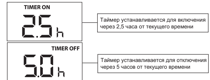
Например: установка таймера на включение через 2,5 часа, рабочее время 2,5 часа и затем автоматическое выключение (см. рисунок ниже)
