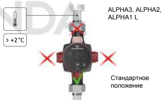
Рис. 17 Возможное положение блока управления для системы отопления
