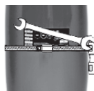
14-сүр. Дубал кронштейнин пайдаланып дубалга куроонун мисалы
