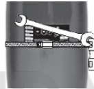
Նկար 14 Պատի վրայի բարձակի օգտագործմամբ պատի վրա տեղադրման օրինակ
