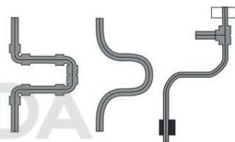
Варианты исполнения компенсатора
