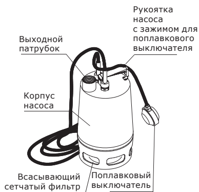
Рис. 1 Конструкция насосов APV.06 / APV.40 V
