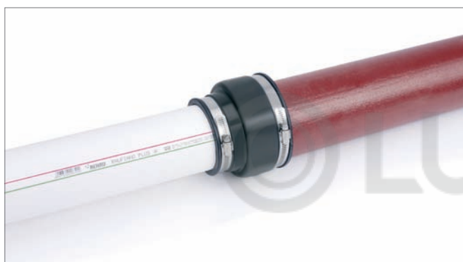
Рис. 7-7 Переход на трубу другого диаметра Ду 110/Ду 90
