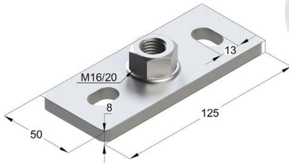
Пластина опорная для тяжелых нагрузок ТВР ХН 8F2
