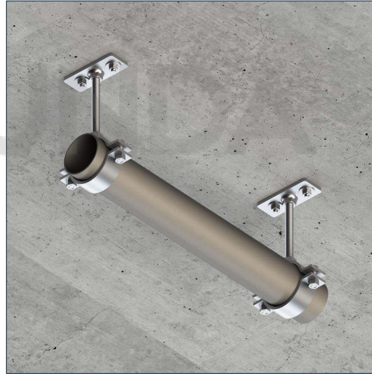
Неподвижная опора на бетонном или другом несущем основании с использованием пластины опорной для тяжелых нагрузок ТВР ХН 8F2
