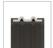
Валикообразный профиль изолирующей вставки
