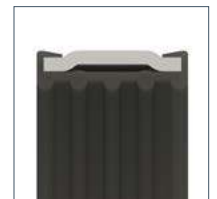
Валикообразный профиль изолирующей вставки
