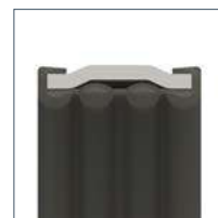
Валикообразный профиль изолирующей вставки
