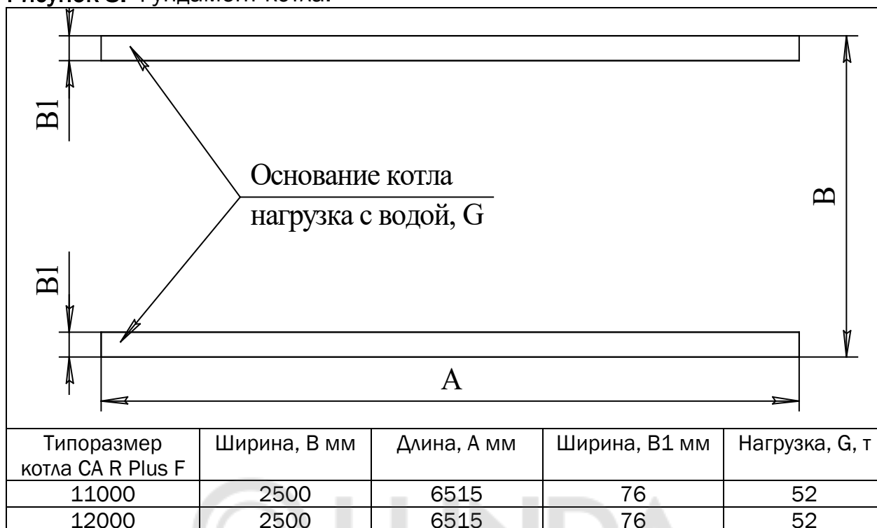
Рисунок 8. Фундамент котла.
