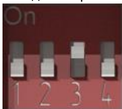
Рисунок 9.64 – DIP-переключатель. Джампер 3 в положении ON
