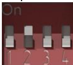
Рисунок 6.4 – DIP-переключатель. Джампер 2 в положении ON
