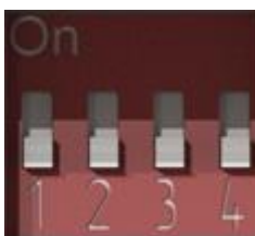
Рисунок 6.6 – DIP-переключатель. Джампер 2 в положении OFF
