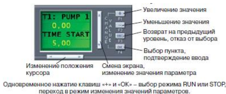
Рис. 3. Работа с кнопками управления логического модуля
