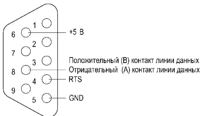
Рисунок 3.2 – Назначение контактов разъема Profibus-DP
