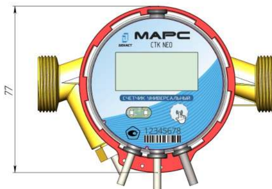
Рисунок 4 — Габаритные размеры СТК MAPC NEO (иные модификации)
