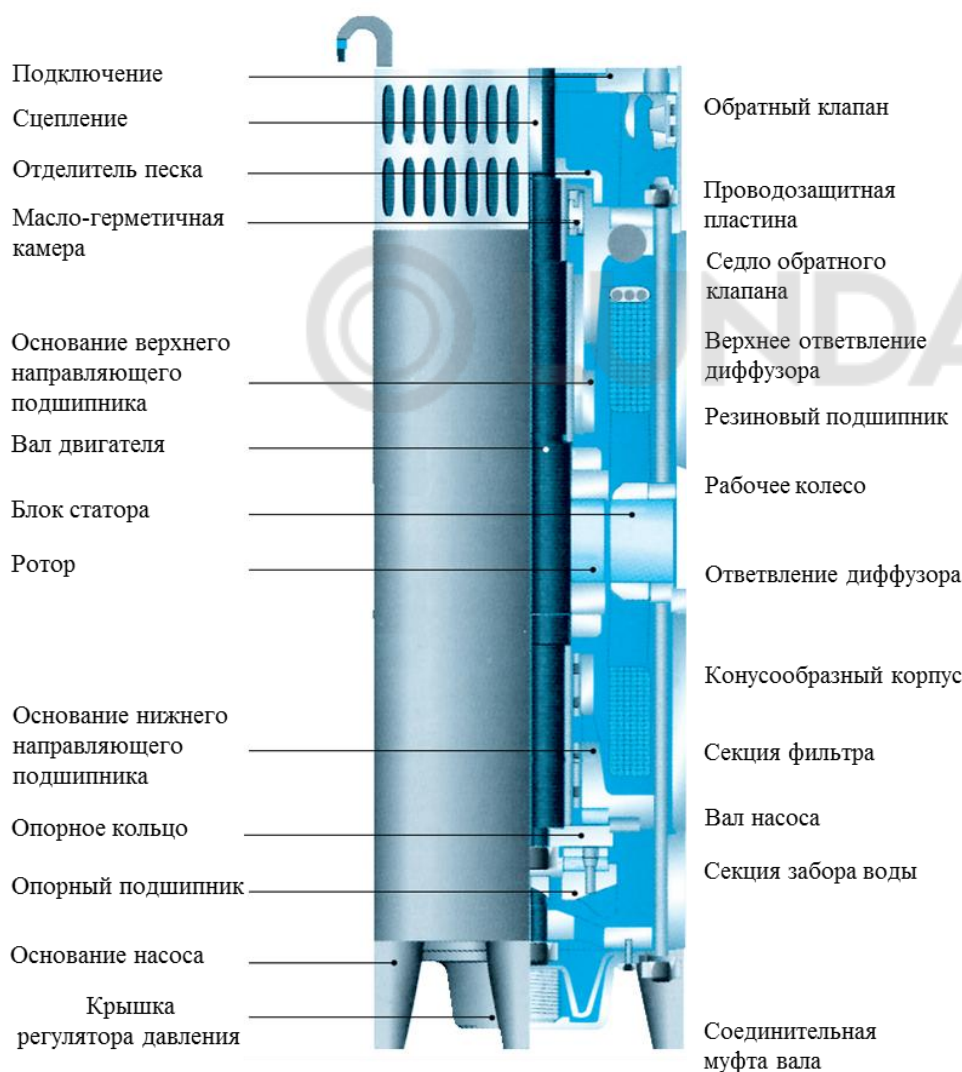
Рисунок 12. Структура двигателя погружного агрегата насосного SM
