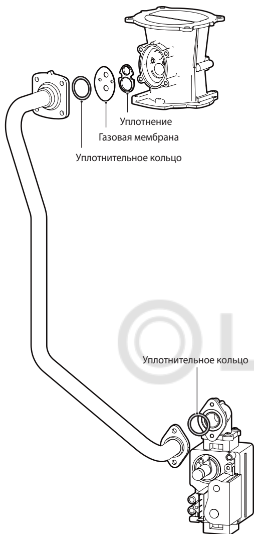
Рисунок 5-2. Газовый узел в разобранном виде (NCB 700-35K)
