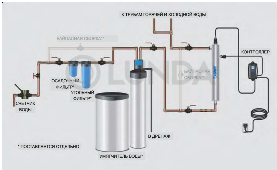
Рис. 1: Рекомендации по сборке УФ-установки BWT Bewades Blue (у точки входа).
