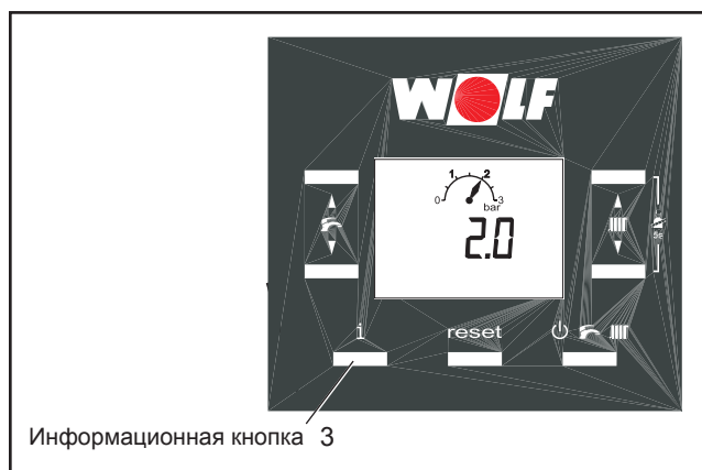
Рисунок. Индикация давления на дисплее системы автоматики
