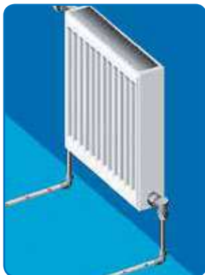
д) Подключение радиатора «боковое, от пола» с помощью хромированных медных пресс угольников. Присоединение медных пресс угольников к радиаторному узлу осуществляется резьбовыми адаптерами для медных трубок.
