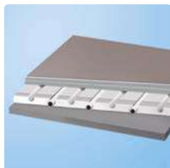
Тёплый пол сухой конструкции Uponor Siccus, в котором функции греющей стяжки выполняют теплораспределительные пластины
