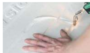
Дополнительные каналы могут быть выпилены электроинструментом
