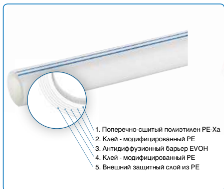
Структура трубы Uponor Comfort Pipe PLUS
