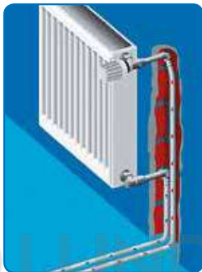
б) Подключение радиатора «боквое, от стены» с помощью хромированных медных пресс угольников. Присоединение медных пресс угольников к радиаторному узлу осуществляется резьбовыми адаптерами для медных трубок.
