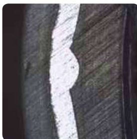
Шов алюминия, сваренного встык
