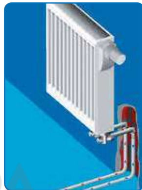
в) Подключение радиатора «нижнее, от стены» с помощью хромированных медных пресс угольников. Присоединение медных пресс-угольников к радиаторному узлу осуществляется резьбовыми адаптерами для медных трубок.
