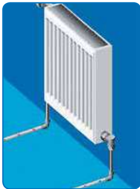
д) Подключение радиатора «боквое, от пола» с помощью хромированных медных пресс угольников. Присоединение медных пресс угольников к радиаторному узлу осуществляется резьбовыми адаптерами для медных трубок.
