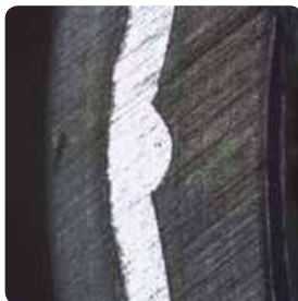
Шов алюминия, сваренного встык
