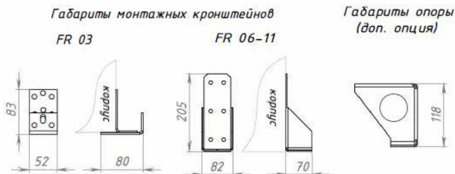
Рис.3 Габариты монтажных кронштейнов и опор агрегата Torvex FR
