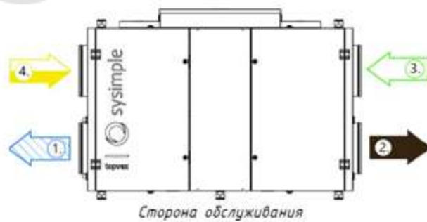
Рис.2 Расположение потоков воздуха в зависимости от левого и правого исполнения агрегата Torvex FR
