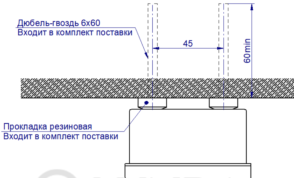
Рисунок 19. Схема монтажа датчика ТДВА к стене
