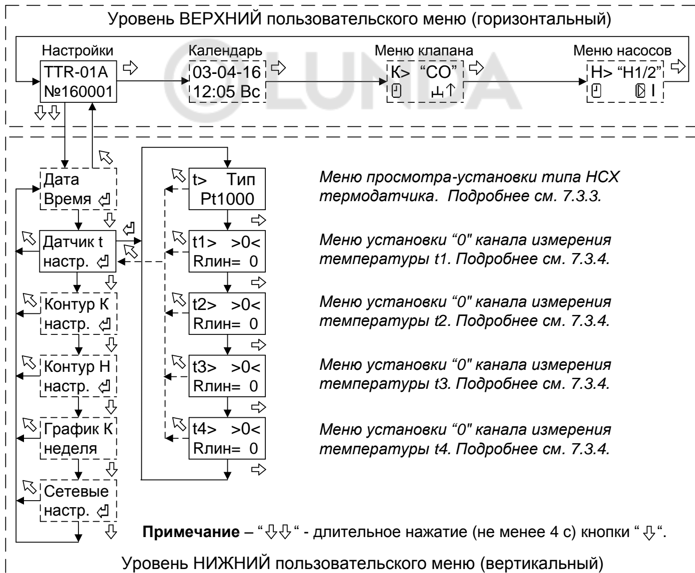
Рисунок 3 - Структура меню настройки канала измерения температуры
