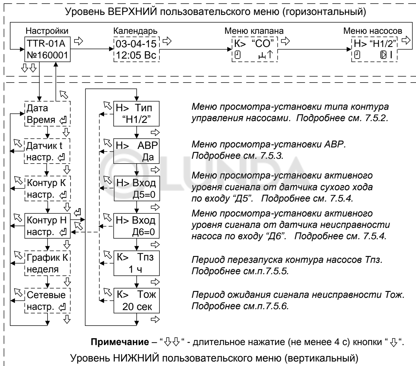
Рисунок 9 - Структура меню настройки параметров контура управления насосами.
