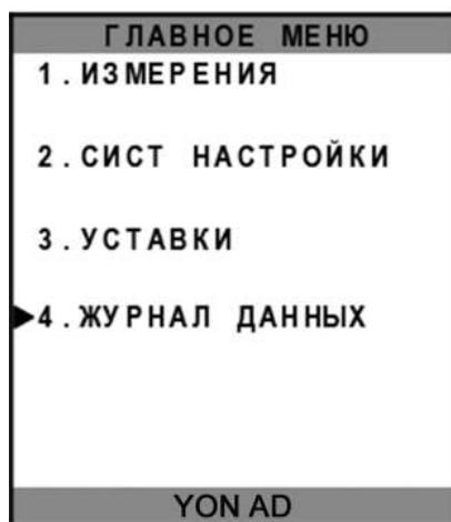
Рисунок 25 – Главное меню микропроцессорного расцепителя MR8.2
