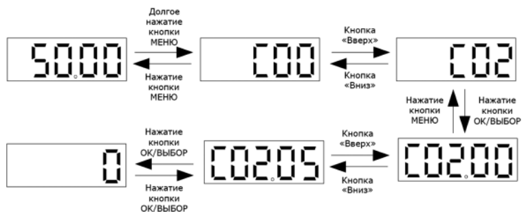
Рисунок 5.5-3 – Основные операции с панелью управления
