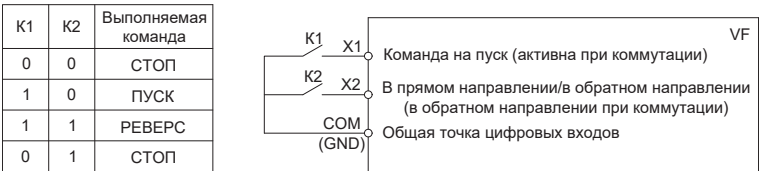
Рисунок 10.9-6. Двухпроводная схема управления 2
