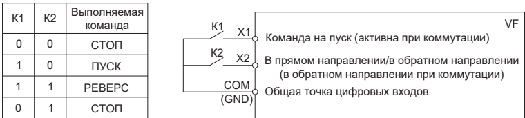
Рисунок 10.9-6. Двухпроводная схема управления 2
