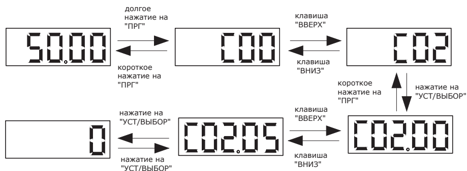
Рисунок 5.5-3. Основные операции на панели управления
