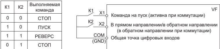
Рисунок 10.9-6. Двухпроводная схема управления 2
