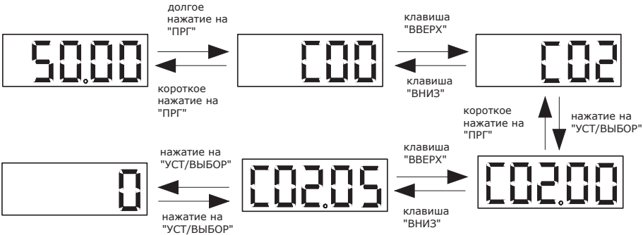
Рисунок 5.5-3. Основные операции на панели управления
