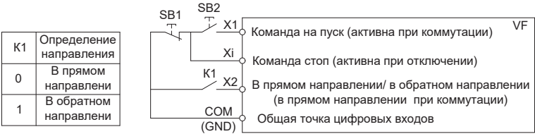
Рисунок 10.9-7. Трехпроводная схема управления 1
