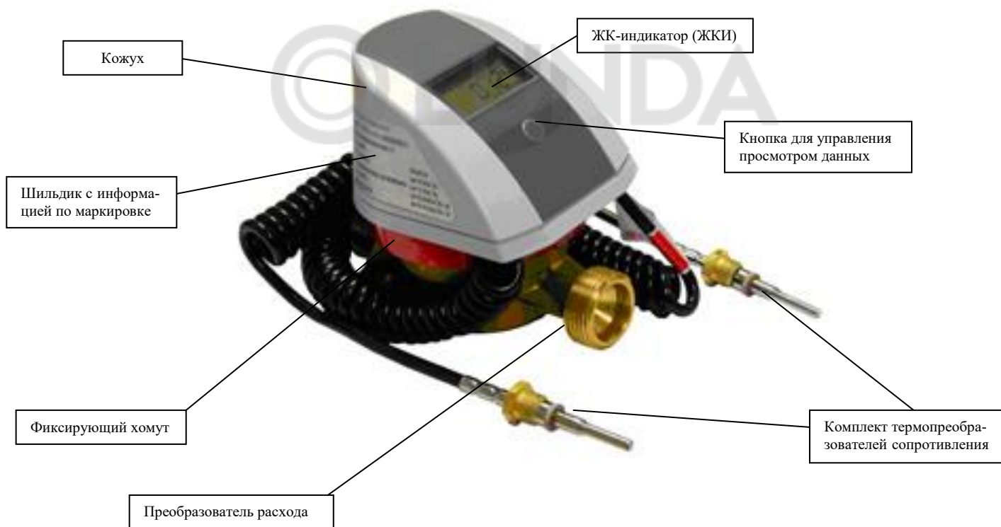
Рисунок 2. Внешний вид и состав теплосчётчика ELF-M
