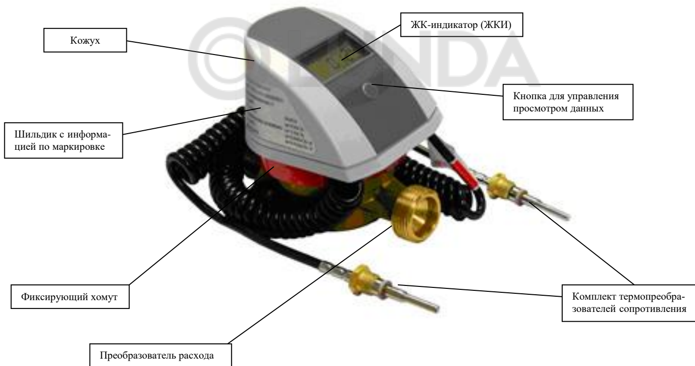
Рисунок 2. Внешний вид и состав теплосчётчика ELF-M
