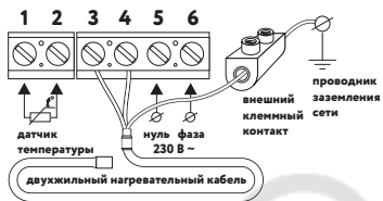
Рис. 2. Схема подключения мата к электрической сети
