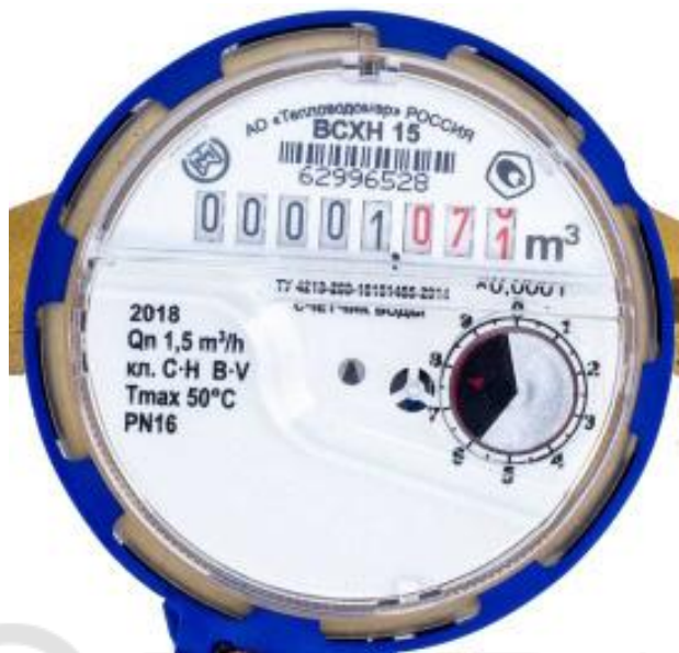
Рисунок 1. Счётный механизм счётчика BCXH-15
