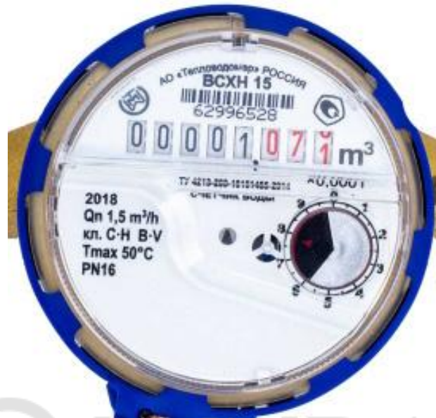
Рисунок 1. Счётный механизм счётчика ВСХН-15
