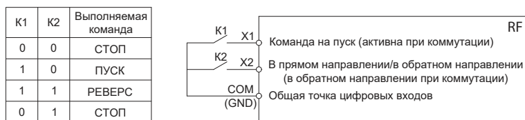
Рисунок 10.9-6. Двухпроводная схема управления 2
