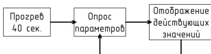
Рис. 4. Блок-схема работы газосигнализатора.
