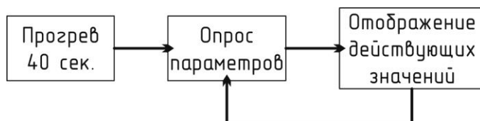
Рис. 4. Блок-схема работы газосигнализатора.
