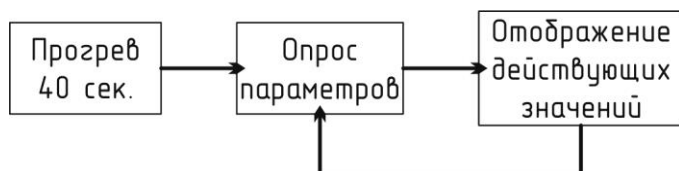
Рис. 4. Блок-схема работы газосигнализатора.
