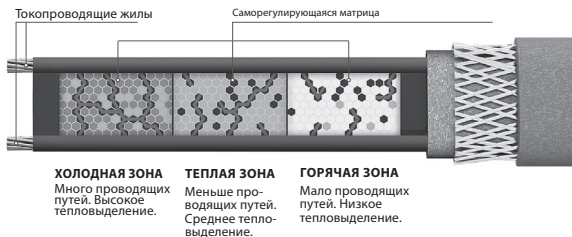
Рисунок 2. Принцип саморегулирования кабеля
