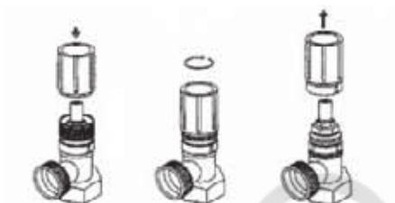
4) Наденьте обратно ручку и затягивайте до момента снятия муфты с корпуса вентиля
