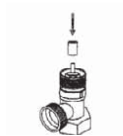
3) Наденьте собачку с внутренним диаметром более 4 мм и высотой 14 мм
