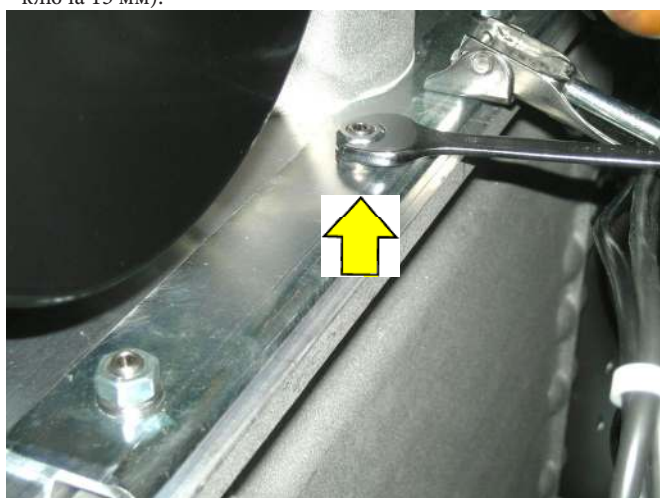
- Вынуть винты "В" (с помощью торцевого ключа 13 мм / ключа-шестигранника 13 мм) и снять крепежные пластины.
