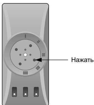
Рис. 3. Расположение штока на термовыключателе термостата.
