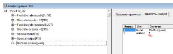
Рисунок 13.4 – Добавление и настройка элемента Modbus (Slave)
