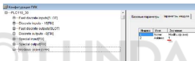
Рисунок 13.13 – Добавление и настройка элемента Modbus (Slave)
